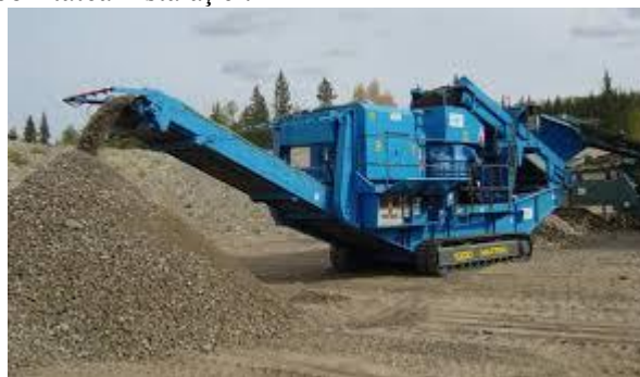
Imagine 3.3.3.2. Instalație mobilă de tratare a deșeurilor din construcții și demolări
