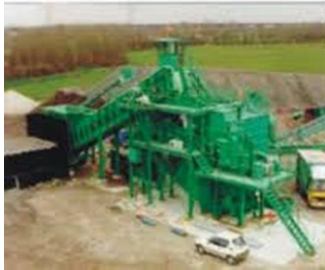
Imagine 3.3.3.1. Instalație fixa de tratare a deșeurilor din construcții și demolări
